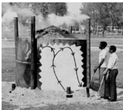
Figura 7 – Horno metálico de anillos desmontables.
