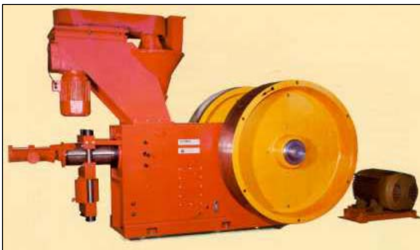
Figura 19 – Briquetera de pistón mecánico (Fuente: Biomax).
